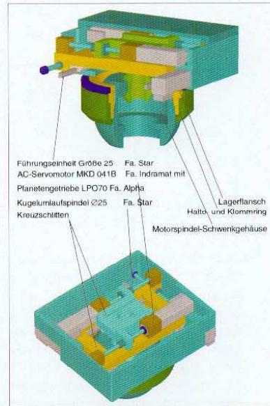
Bild 2. Kompaktes und schlüssiges Konstruktionsprinzip: Im Kugelschwenkkopf sind 30 Prozent weniger Bauteile integriert als in herkömmlichen Rotations-Schwenkköpfen
